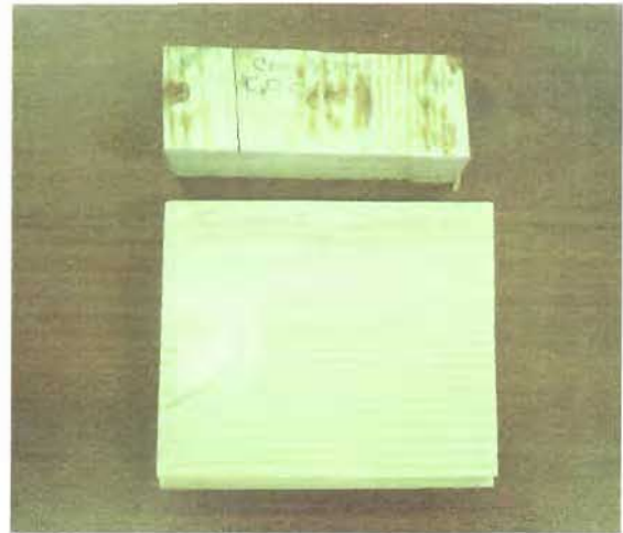
Фото № 2. Образцы сырой (вверху) и сухой (внизу) древесины.
