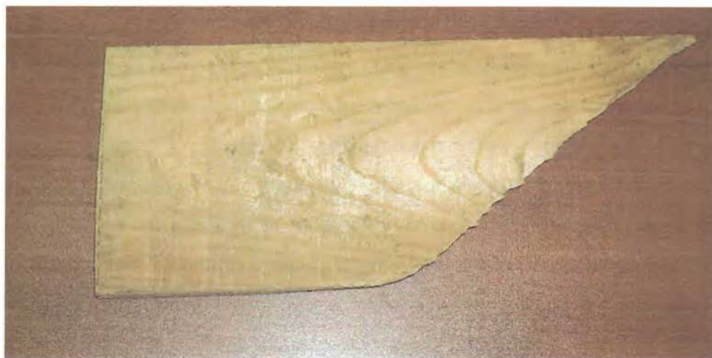
Фото №1. Механически необработанный образец №1, в виде обломанной с одной стороны доски.
