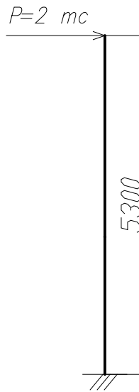
Рисунок 2 – Расчетная схема сваи
